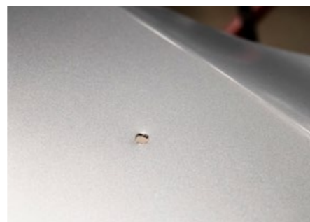
Borrhål i kaross – ej fackmannamässigt utfört.
