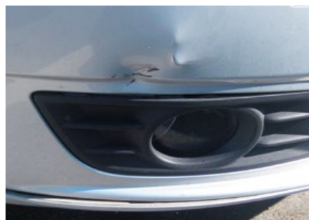
Större bucklor, repor och/eller deformationer i karossen som tydligt påverkar det generella intrycket. Skador som kan föranleda rostangrepp.
