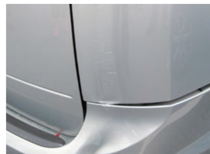
Brottskada, sprickor eller liknande skador på stötfångare eller tillhörande detaljer. Täckplatta för bogserögla eller för dragkrok saknas.
