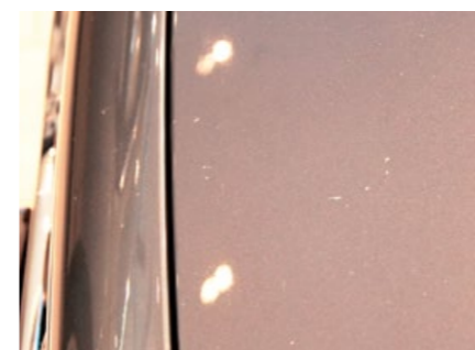
Enstaka mindre lackskada genom ytskikt som inte gått igenom till underliggande plåt eller plast.
