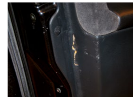
Revor, hål och sprickor i klädsel, på dörrar och andra inredningsdetaljer.
