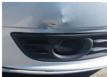
Buckla där lacken är skadad ner till grundlacken eller till underliggande plåt eller plastskikt. Gäller oavsett storlek på bucklan.
