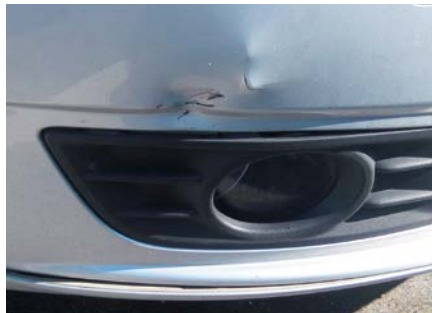
Buckla där lacken är skadad ner till grundlacken eller till underliggande plåt eller plastskikt. Gäller oavsett storlek på bucklan.
