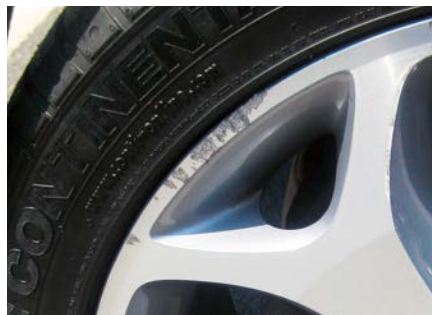
Fälgar med deformerade kanter, sidokast eller ovalitet.
