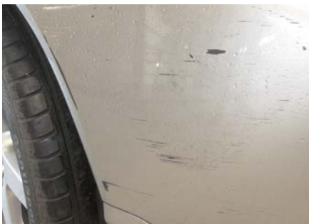
Flera lackskador ner till underliggande plåt eller plast.
