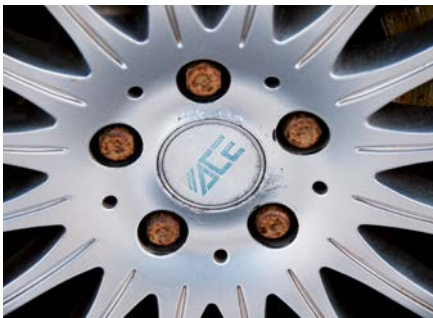
Rost på hjulmuttrar eller bultar som inte påverkar funktion eller säkerhet.
