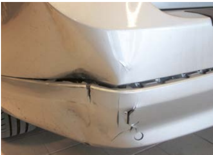
Bucklor eller skador med en diameter eller storlek över 20 mm.
